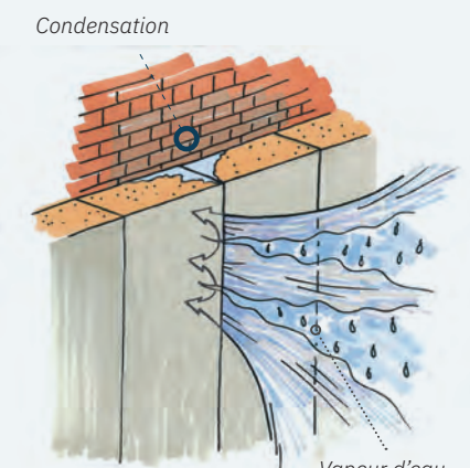
Fuite d'air par le complexe isolant
