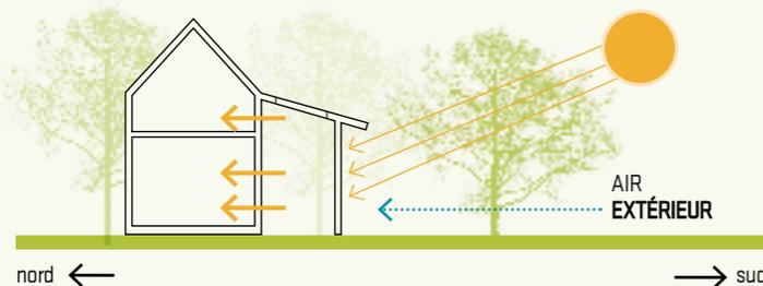
En hiver, la serre permet de réchauffer l'air ainsi que la partie maçonnée à forte inertie en fond de serre qui retransmet lentement la chaleur à l'habitation.
