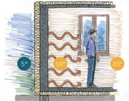
*Isolé (paroi chaude)  $\frac{18^{\circ} + 20^{\circ}}{2} = 19^{\circ}$*
