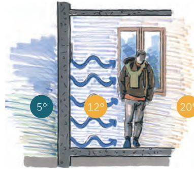
*Pas isolé (paroi froide)  $\frac{12^{\circ} + 20^{\circ}}{2} = 16^{\circ}$*
