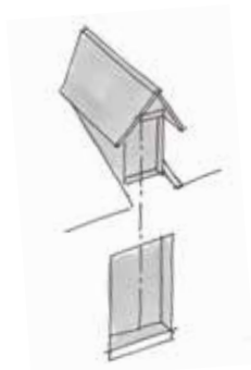
Lucarne à bâtière, verticale, à l'aplomb de la façade.
