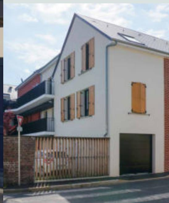
Pour une clôture neuve, des matériaux « nobles » peuvent être mis en œuvre en parement d'un mur en parpaings. Cette solution est moins coûteuse qu'une maçonnerie réalisée de façon traditionnelle. Les clôtures peuvent être en bois laissé brut, qui prendra naturellement une teinte grisée-argentée avec le temps. Léger et facile à mettre en œuvre, le bois présente une grande variété d'agencement et de finitions possibles.
