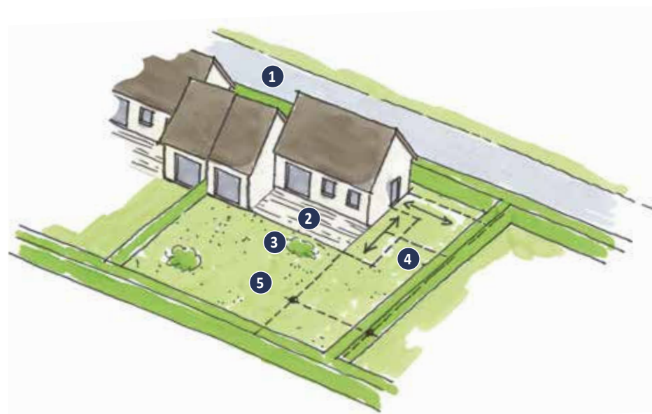
▲ Construction en limite de parcelle préconisée
